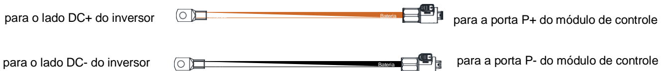
Figura 4-6 Terminal OT crimpado
