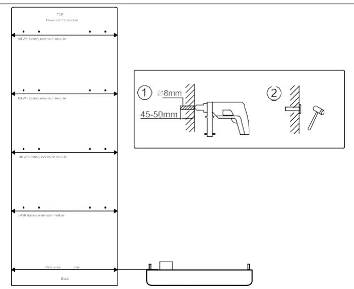
3. Trave os parafusos nos orifícios de ambos os lados do módulo de extensão da bateria, para garantir que o módulo de extensão esteja bem instalado na base; fixe a âncora de parede no módulo de extensão da bateria e, em seguida, fixe-o na parede. Da mesma forma, instale outros módulos de extensão da bateria e fixe-os. Ferramentas: parafuso combinado M4x14, parafuso de cabeça escareada M4x10, parafusos de rosca  $\Phi 8 \times 40$ , chave de torque M4, chave de torque M6.
