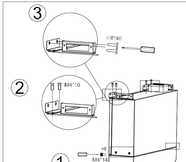
4. Prenda o módulo de controle de energia no módulo de extensão da bateria. Em seguida, insira as tampas protetoras em todos os orifícios dos parafusos em ambos os lados.
