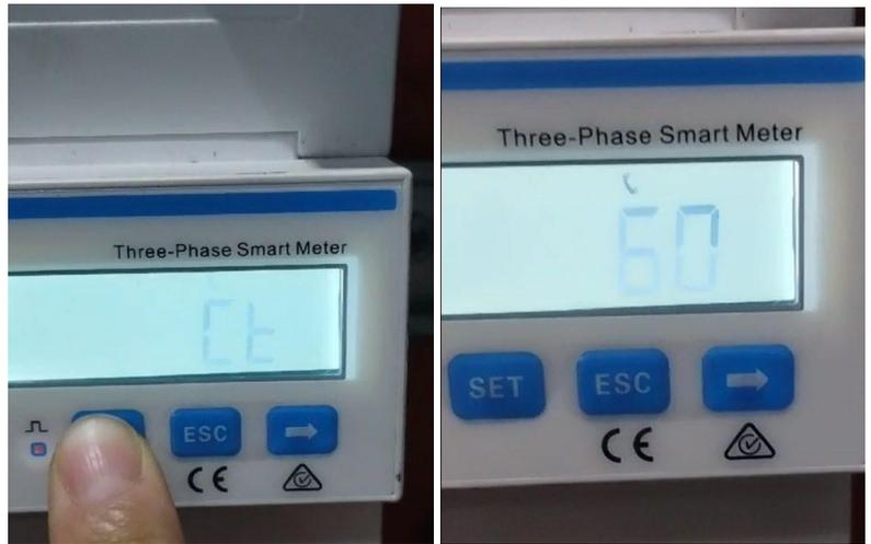
As outras opções são **Prot**, **Addr** e **baud**. Em **Prot**, coloque **n. 1**, em **Addr** deixe como **1**, e em **baud**, coloque **3**.
