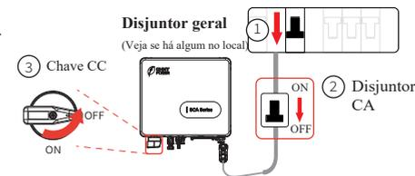
A instalação deste equipamento deverá atender às normas técnicas vigentes para instalações elétricas fotovoltaicas (NBR 16690) e gerenciamento de risco de incêndio em sistemas fotovoltaicos (IEC 63226).
